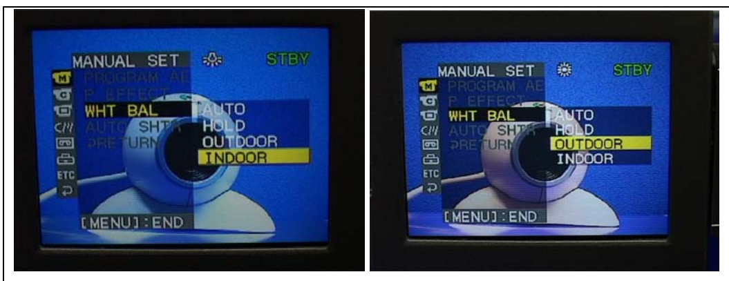
(Abb. 4: Weißabgleich für Innenaufnahmen (li.) und Aussenaufnahme (re.))
